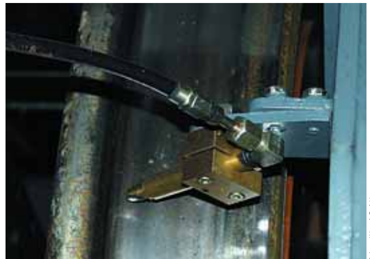
Einstoffdüse mit Zuleitung für Schmierstoff-Luftgemisch (Fabrikat Beka Fluilub). Single nozzle with feed for lubricant-air mixture (type Beka Fluilub).
